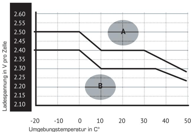
A = Ladespannung für max. 12 Stunden > 35C° max. Ladespannung von 0,5 A/AH
